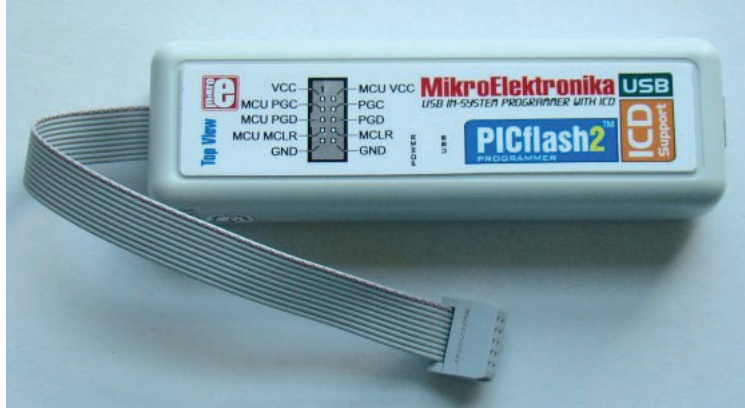
Şekil E.4 Devre içi hata ayıklamada kullanılan örnek bir donanım
